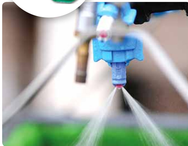
Widok strumienia cieczy w rozpylaczu eżektorowym ALBUZ Twin.
